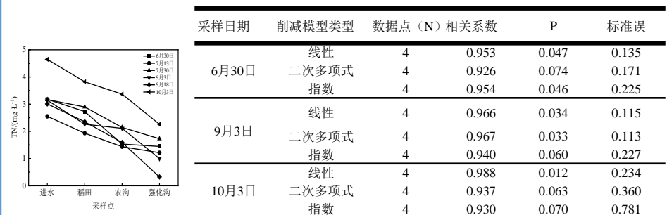
图3 稻田生态利用系统沿程p(TN)变化与沿程削减模型检验结果
